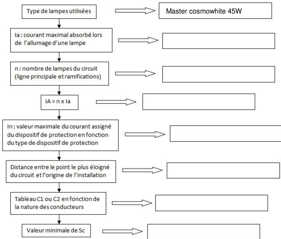
D1.7     **Choisir** la protection adaptée sachant que le pouvoir de coupure est imposé à 10 000A :
