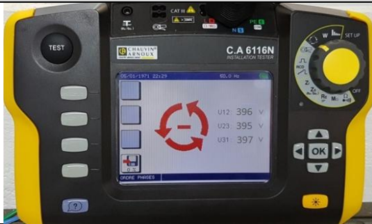
MESURE APRES TRAVAUX A L'ENTREE DU VARIATEUR
