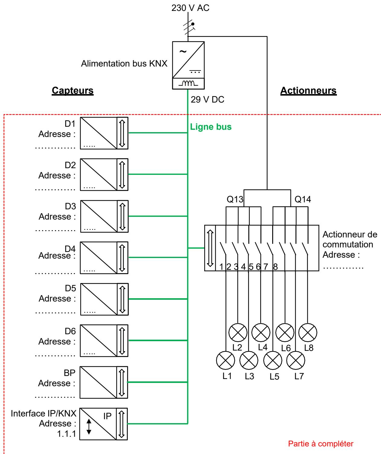
Il s'agit à présent de programmer le bouton poussoir et l'actionneur de commutation afin de commander l'éclairage du local électrique.
