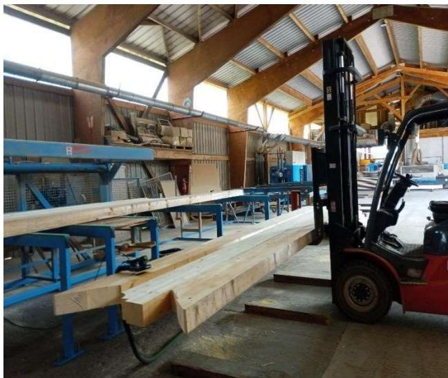
Actuellement, la sortie des pièces rabotées mobilise un manutentionnaire qui assure l'évacuation des pièces avec un chariot élévateur et nécessite l'arrêt du transfert en amont des charpentes pour des raisons de sécurité.
